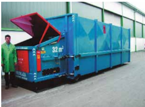
Stacionarna stiskalnica 32 m 3
