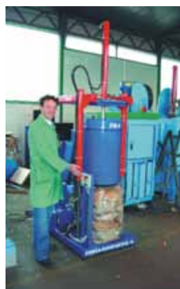
Stiskalnica - kompaktor 5 t PK5 Stiskanje v PVC vreče, enostavno in praktično
