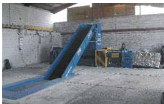
Avtomatska stiskalnica za baliranje - horizontalna / potisna moč 50t APB-50 s transporterjem
