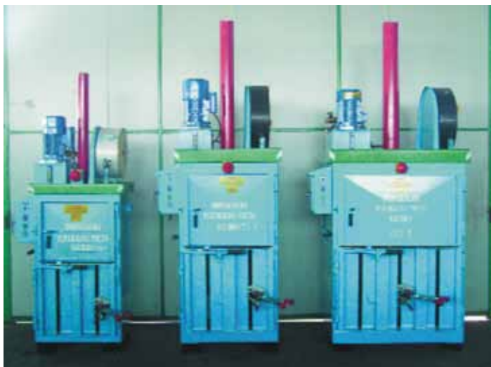
Stiskalnica za baliranje - vertikalna / potisna moč 10, 15 in 20 t
