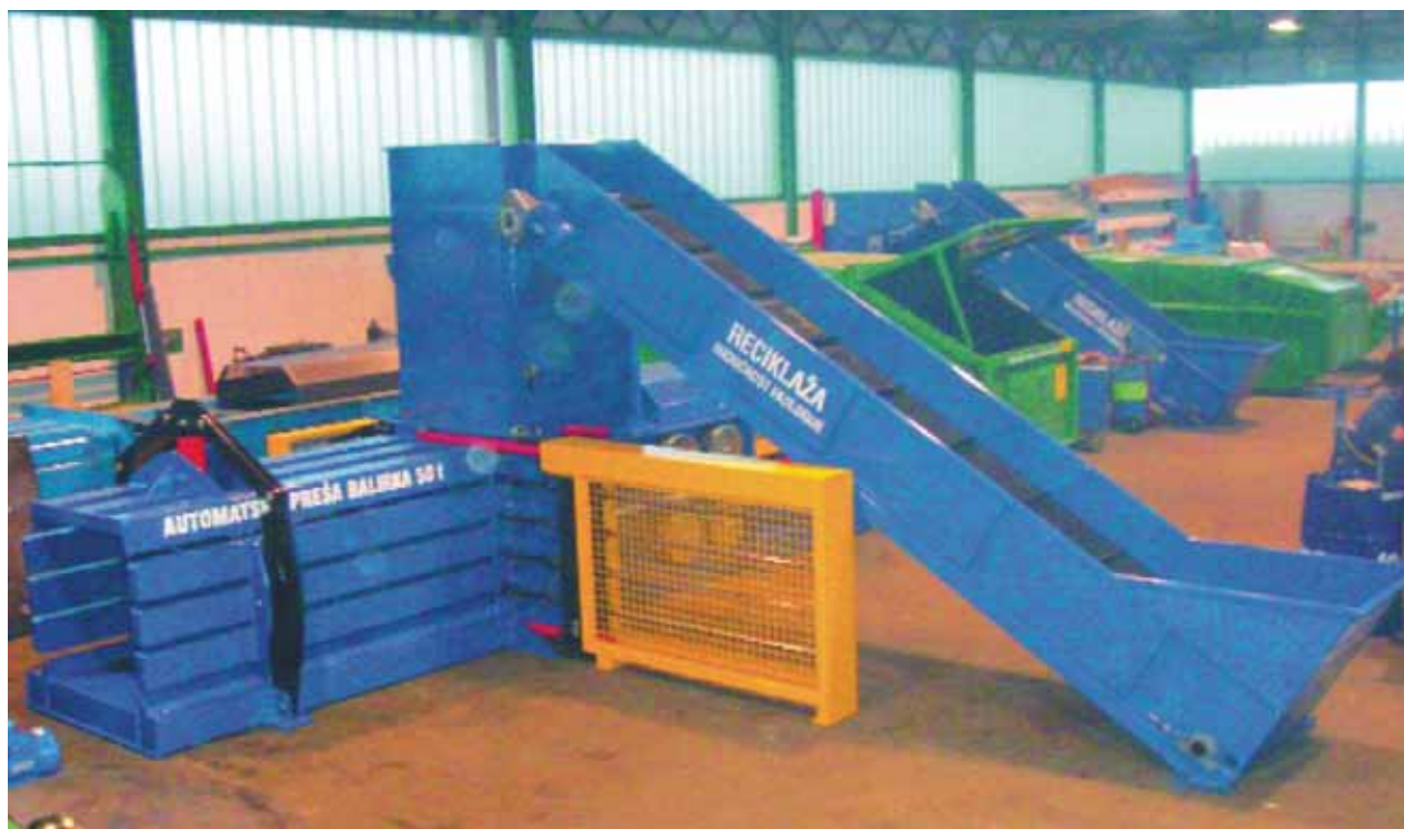
Avtomatska stiskalnica za baliranje - horizontalna / potisna moč 50t APB-50 s transporterjem
