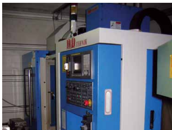
Vertikalni CNC center, delovno območje 750x510x510, Vertikalno CNC center, delovno območje 650x500x500
