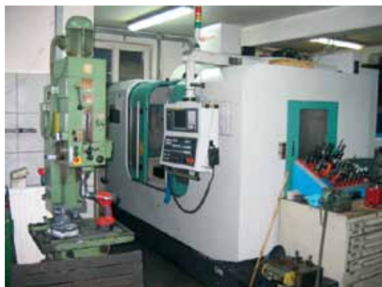
Vertikalni CNC center, delovno območje 1300x800x800 Vertikalni CNC center, delovno območje 1220x780x780
