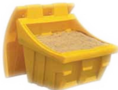
Vigrad Winter 50, 100, 150, 300 kg, Dimenzije: 590 x 540 x 500 mm, 720 x 660 x 590 mm, 860 x 740 x 810 mm, 1090 x 970 x 1030 mm,
